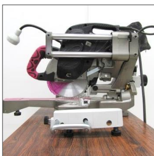
スライドソー 木材の切断
