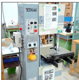
コンターマシン 板金の切断
